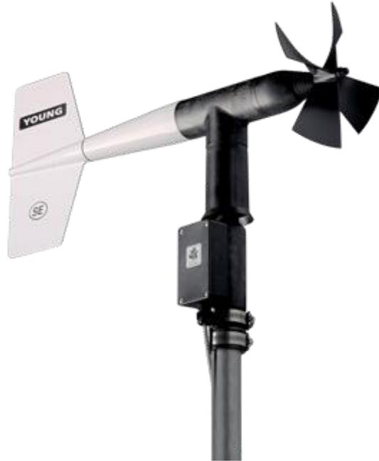
09101 风速风向传感器结合了 RM Young 公司标准风速风向传感器的性能和耐久性，而具有独立的光电编码器风向变送器和串口信号输出功能。
