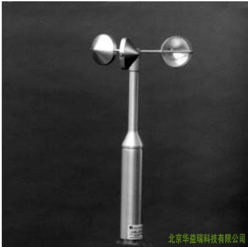
010C 风速传感器可以\*\*测量水平方向的风速，提供详细的水平风速信息。它的应用极为广泛，尤其在对快速反应和低风速启动要求比较高的场合，更能发挥其特长。传感器的启动风速为 0.5mph，在整个标定的量程中，其精度可达到 $\pm 1\%$ 。010C 风速传感器可以连续工作在诸如从南极冰川到干旱沙漠的恶劣环境中。
