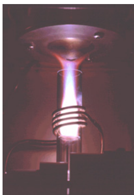
普通的氩气反吹尾焰消除方式，这种方式下的炬管很容易变脏。
