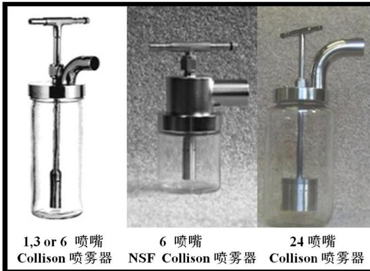
很久以来美国 BGI 公司研制的 Collison 喷雾器都被公认为将各种液体气溶胶化的最有效技术。Collison 喷雾器包括许多不同配置的喷雾器，经过了广泛的性能测试以确保满足不同用户的具体要求。
