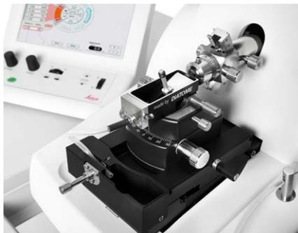
ARTOS 3D 可自动创建连续切片，更快地完成切片制备。量身打造的钻石刀可从一条无皱切片带无缝转移到下一条，不会出现厚度差异。
