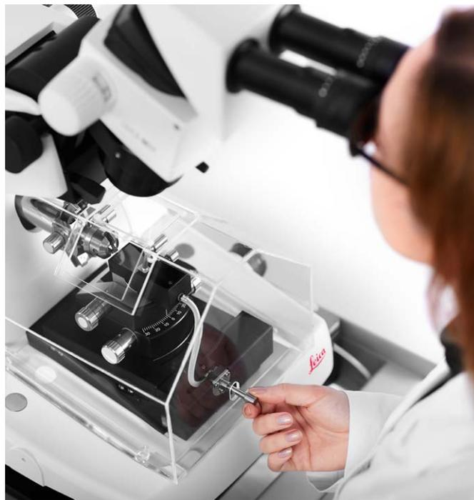
只需调节 ARTOS 3D 的前阀门即可控制水流量，从而避免切片带起皱。在 ARTOS 3D 防风罩和主动阻尼系统的作用下，还可获得更加一致的切片厚度。
