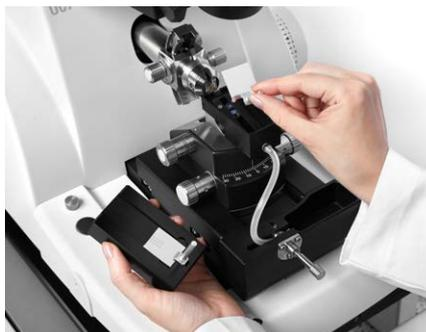
使用 ARTOS 3D 的用户预定义程序，可快速设置连续切片。可在整个工作流程中使用小切片托架，从而实现切片到成像的顺利转换。
