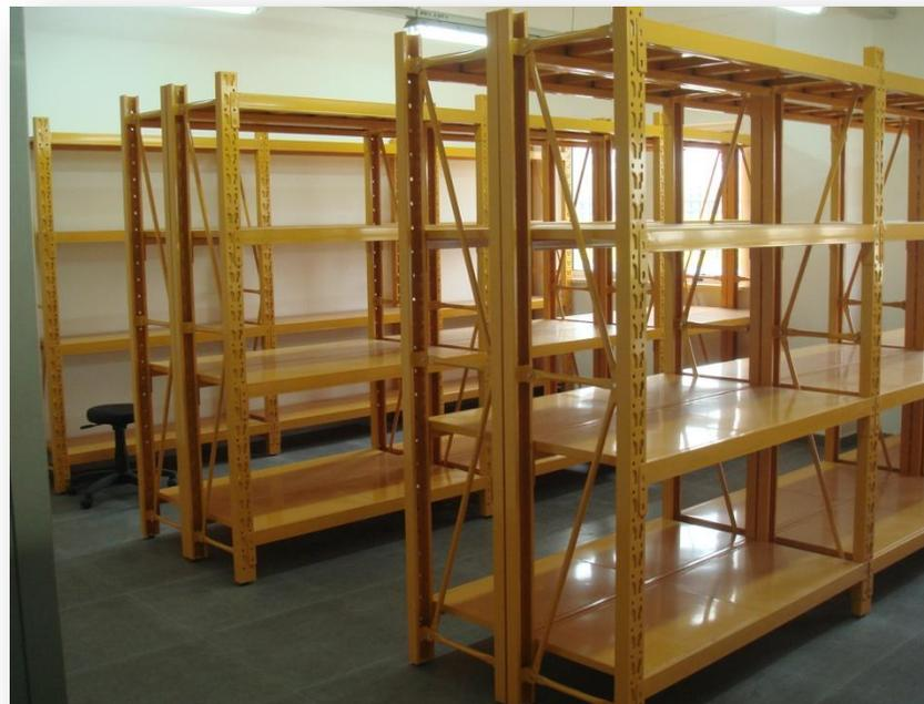
实验室货架钢骨结构为 1.5mm 厚度冷扎薄板,层板采用 1.0mm 厚度冷扎薄板,所有表面经环氧树脂粉末喷涂,非常结实,其表面采用静电粉末处理,防腐、防锈,坚固耐用,横梁采用型材 40\*60 P 型管加工而成实验室专用货架,货架的旁侧竖杆上有很多螺丝眼,可根据实际需要自由调节置货层数和每层之间的高度,外型美观、结构简单、安装拆卸方便、不用任何螺栓,不占空间,款式的可选性能保证完全满足使用的需要。
