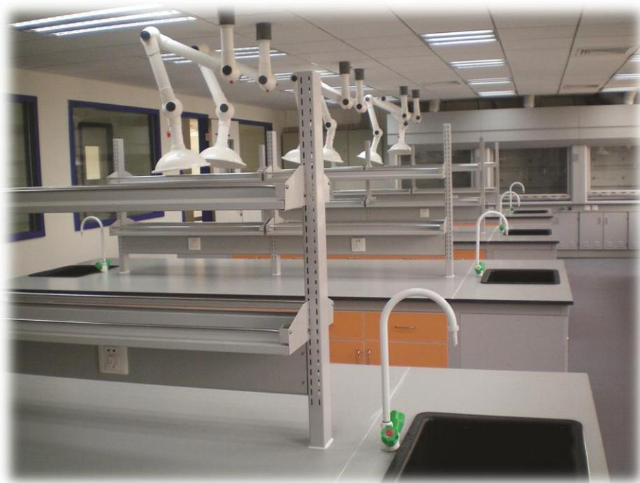
钢木实验台采用 C 型结构，灵活多变，承重性好，清洁和经济实用等诸多优点，使其成为当前很多实验室的首选类型，以表面喷涂环氧树脂的方钢生产制造的框架，配以色彩丰富，款式多变的木制柜体，达成了实用和美观的完美结合，采用实验室专用 C 型钢框架结构和模具冲压标准化连接件，坚固耐用。粉末喷涂后经高温处理，耐酸碱、抗腐蚀，不锈钢承重可调高度地脚，高度范围 50mm，台面、柜身材质可根据用户要求配制，结构合理，承重能力强，美观耐用。
