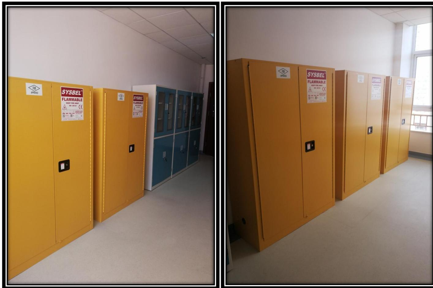
实验室安全柜用于规范储存易燃液体及某些危险化学品,各种不同尺寸的防火安全柜能为可燃、易燃液体及化学品提供安全储存,体积小巧的化学品储存柜,能够摆放在工作场所存放可燃、易燃品及有机溶剂,小型防火安全柜能为可燃、易燃液体及化学品提供安全储存。
