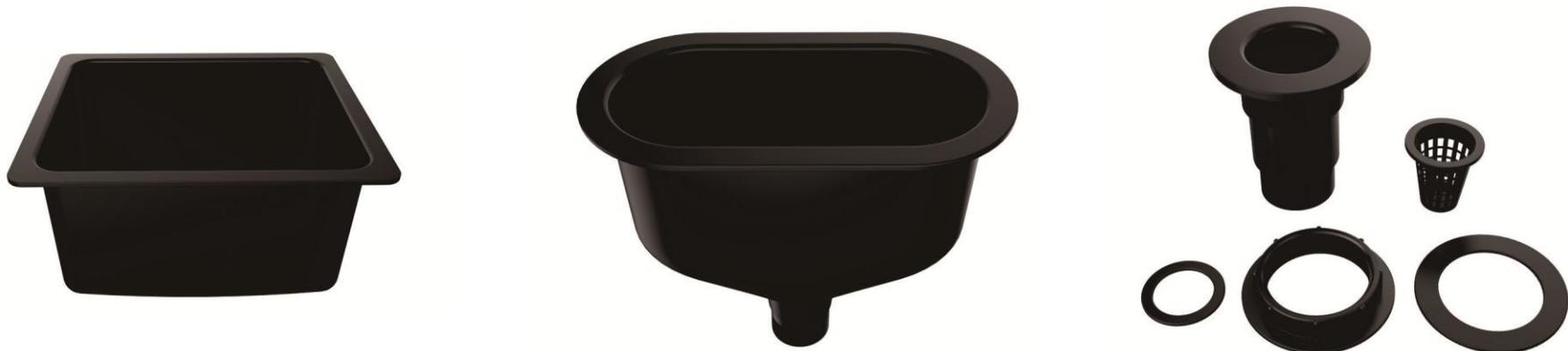
实验室用水槽除需符合实验室实验用品材料方面的特殊要求，如，耐酸、碱、腐蚀之外，还应便于清洗、安装和更换，实验用水槽分为一体成型，即，在生产时与实验台面板一次压制成型，特点是无缝、便于清洗，还有一种是与实验台分开之后组装在一起的，有缝隙，废液容易渗入缝隙中，制作材料有 PP 塑料、陶瓷、水泥和环氧树脂等。
