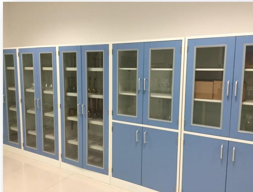
全钢试剂柜又称全钢药品柜柜体结构采用厚 1.2mm 的冷轧钢板模压成型，所有柜体表面均经过 EPOXY RESIN 粉末静电喷涂处理，具有抗酸碱、防化、防潮、耐高温以及耐磨，柜体中隔板由四个钢制层板扣支撑，高度可任意调节，13mm 可上下移动，承重为 30kg。
