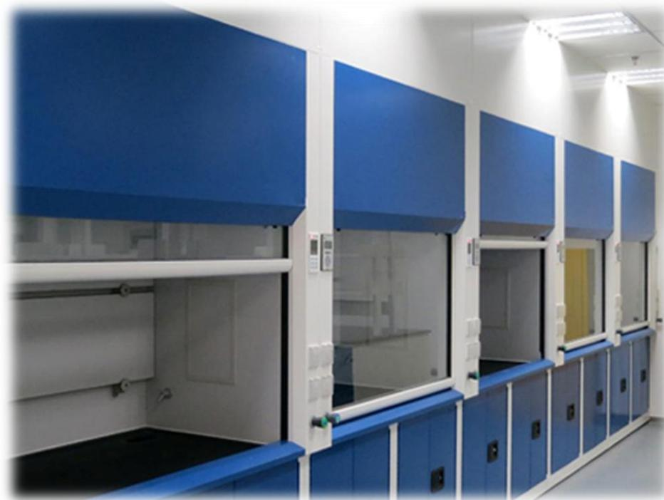
全钢通风柜在实验室通风设备中最主要的设备,它使用范畴广,抽风量大,工艺要求也高,通风柜选择的好坏直接关系到实验室的整体通风系统,通风柜采用三段式平衡导流构造,提高排烟功效,移动玻璃门采用无断式平衡装置,可上下拉动停留在任意位置,钢制外壳采用 1.2mm 厚冷轧钢板模压成型,柜体表面均经过 EPOXY RESIN 粉末静电喷涂处理,具有抗酸碱、防化、防潮、耐高温以及耐磨。
