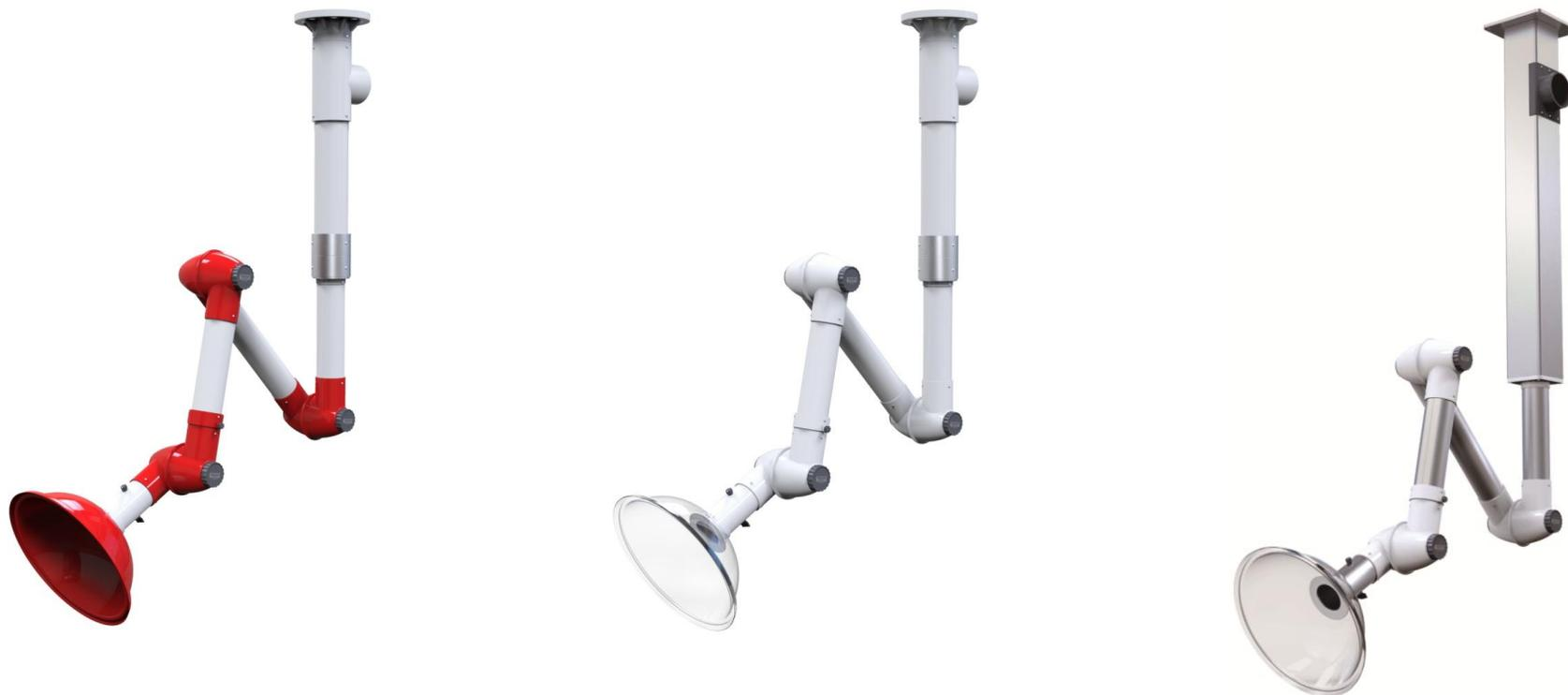
关节：采用高密度 PP 聚丙烯材质，可 360° 旋转调节方向，易拆卸、重组及清洗 关节密封圈：采用不易老化的高密度橡胶。 关节连接杆：304 不锈钢连接杆。 关节松紧旋钮：高密度 PP 材质，内嵌不锈钢轴承，与关节连接杆锁合。 气流调节阀：方便的手动调节外部阀门旋钮，控制进入之气流量。 集气罩：PP 白色/红色/透明，PC 全透明大罩。
