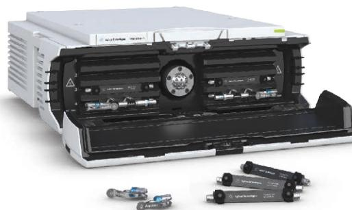
InfinityLab Quick Connect 快速连接接头和 Quick Connect 快速连接热交换器易于安装。
