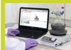
控制并记录加热磁力搅拌器
