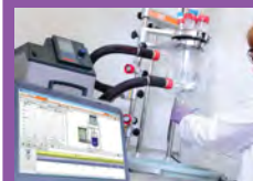
控制并记录顶置搅拌器和加热/制冷循环器
