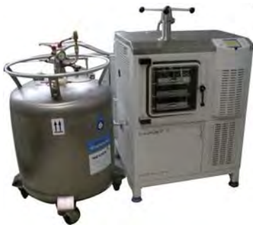
液氮冻干机 实现速冻功能（5°C/min），更低冷阱温度（-100°C），更低隔板温度（-80°C）
