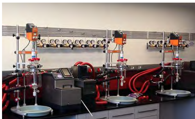
Reactor Ready Duo反应釜 釜体兼容范围：100ml~5L 单釜架、双釜体 (两边釜体温度不同)
