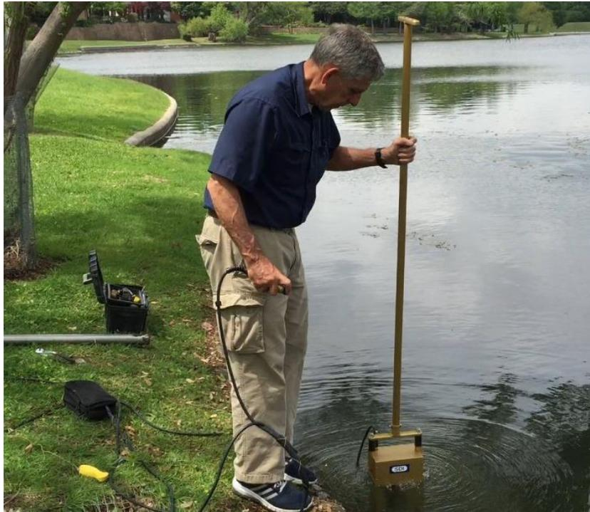
P 型取样器同样可以在取样管安装独特岩心爪，以便于更有效率的在沙土环境或者软沉积物环境取样。独特的设计使得取样管能在采样后较容易的从水中脱离。顶部的浮动排气和密封系统有助于实验人员收集非常柔软的沉积物样品，并且几乎无须损失任何样品。
