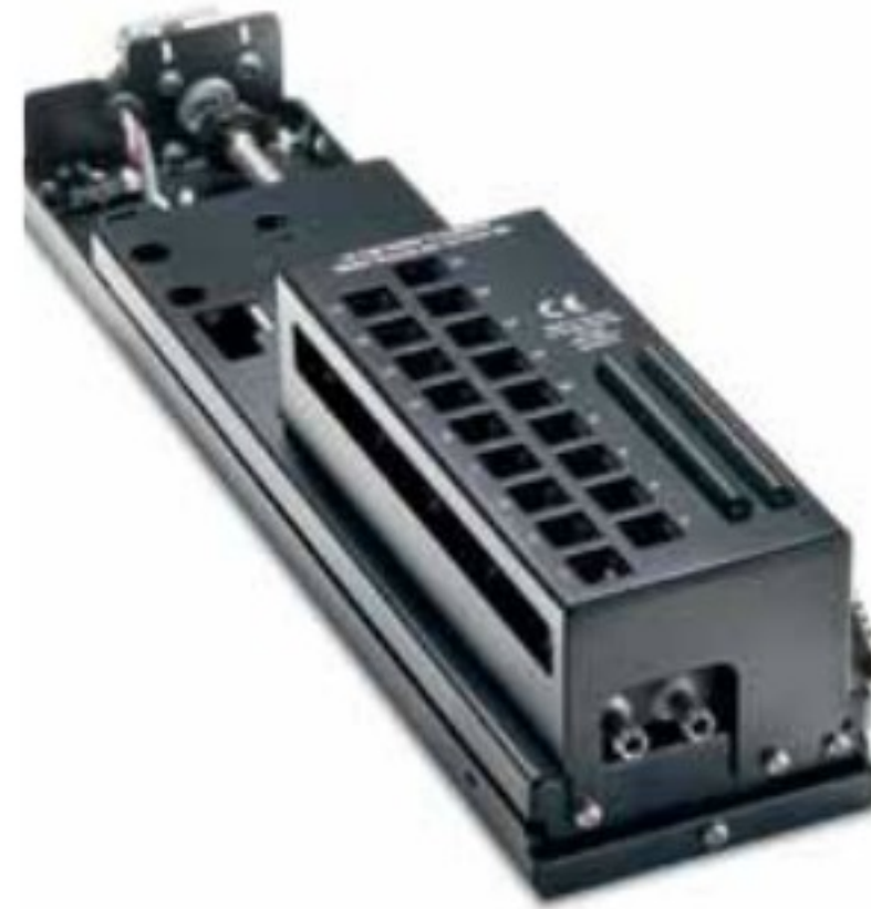
快速测量多个样品 多池支架可同时支持 18 池，并且能够连接水浴用于精确控温。
