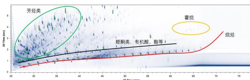
一维柱 : Rxi-5Sil-ms 30m\*0.25mm\*0.25μm
