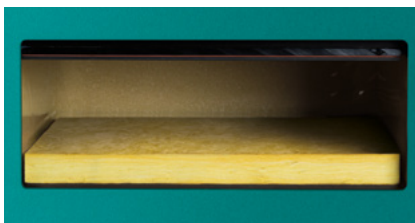
更换样品时，HFM 446 Lambda可以控制上板不同程度的开启。
