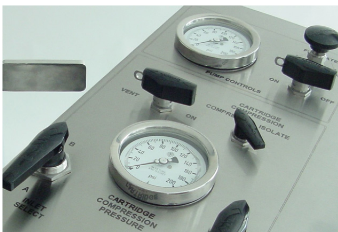
图 18. 操作控制面板位于设备顶部，分为三个部分，操作简单，易于控制，液压绞车用于拆卸径向压缩模块，装入色谱柱。
