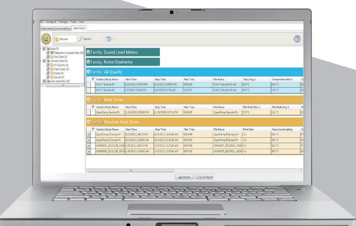
软件能够兼容 TSI Quest 具有数据记录功能的检测仪器，将帮助您生成声学、热指数和环境监测的报告，提高您的操作效率。
