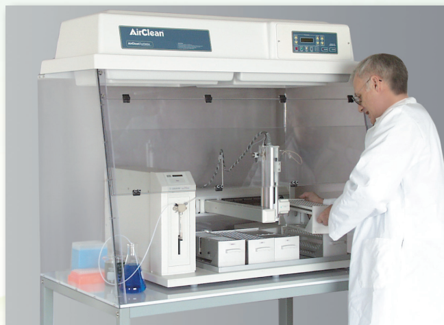
Gilson吉尔森215 SW工作台，对有毒化学烟雾和蒸汽加以隔绝
