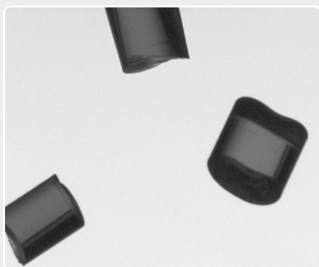
CAMSIZER® P4 所使用的全幅摄像头能够在检测颗粒形态时不失真的记录下真实的颗粒投影影像
