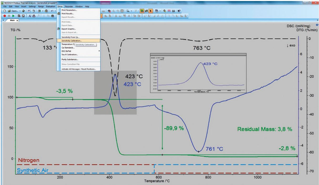
分析过程中的用户界面：TGA曲线（绿线）与DTG曲线（黑色虚线），DSC曲线（蓝线），氮气流量（红色虚线）和空气（蓝色虚线）的曲线；PIP（画中画）显示DSC峰值在423°C。
