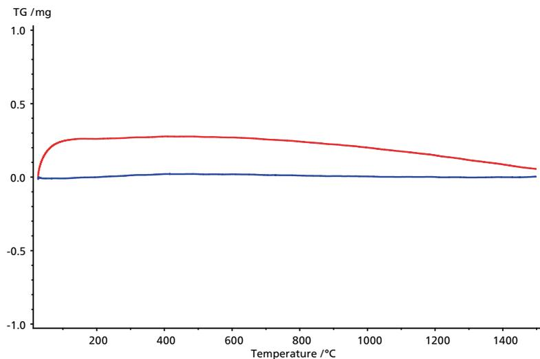
BeFlat®的影响：蓝色曲线表示使用BeFlat®校正的TGA测试；红色曲线，没有进行修正。在相同条件下、使用两个空坩埚进行测试。
