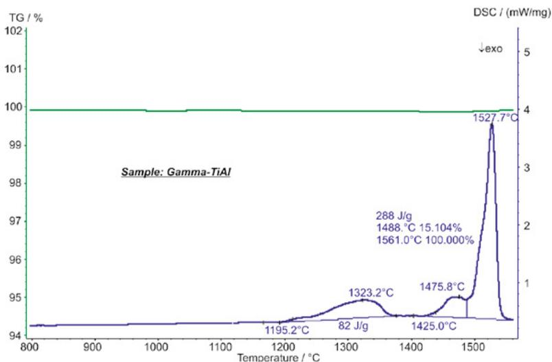
TiAl合金 (32.08mg) 的相变测试, 采用Rh炉以20K/min升温至1600°C
