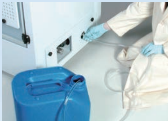
自动废液泵可以把废液抽送到干燥柜60m"以外的地方
