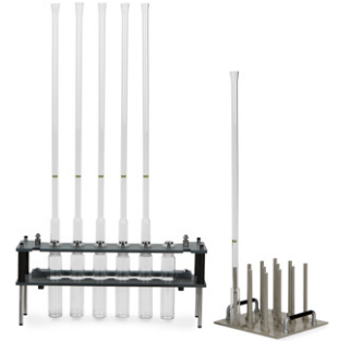
化学需氧量 (使用空气回流冷凝器)
