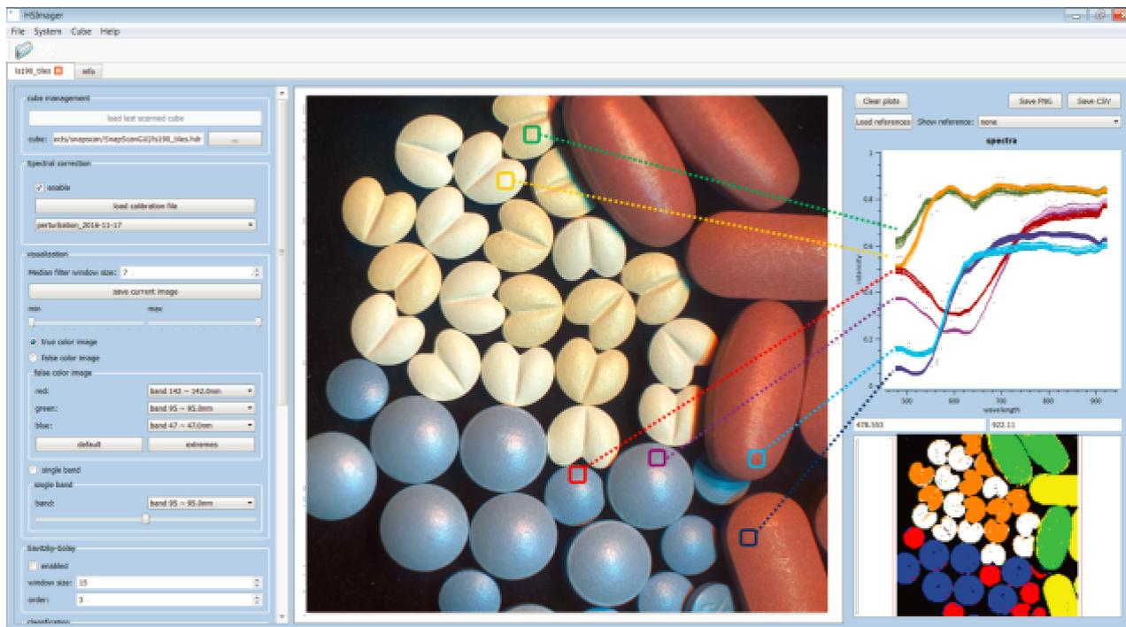
光谱数据合成的 RGB 彩色图像， 右上角为不同药片的光谱曲线， 右下角为光谱分类的伪彩色图像
