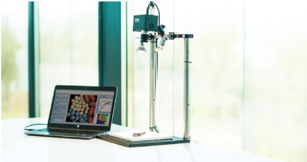
SNAPSCAN 便携式高光谱成像系统，采用 IMEC 公司独有的像元镀膜的分光技术，改变了传统高光谱仪需要狭缝及光栅的分光模式，与传统的高光谱仪相比较，具有体积小，分光效率高，高光谱数据采集速度快，最快 2 秒可获得高光谱立方体数据，内置制冷系统，可获得高信噪比的高光谱数据，由于采用大面阵探测器，系统可获得的空间分辨率高达  $2048 \times 3650$ ，光谱通道数约为 150 个波段，系统通过 USB3.0 接口传输数据，操作简便，配置灵活，是一套便携、分辨率高、性价比高的光谱成像仪。可以应用在高空遥感，野外光谱成像目标识别，室内高光谱成像检测及显微光谱成像；
