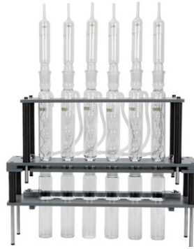
微量金属和羟脯氨酸 (使用水回流冷凝器)
