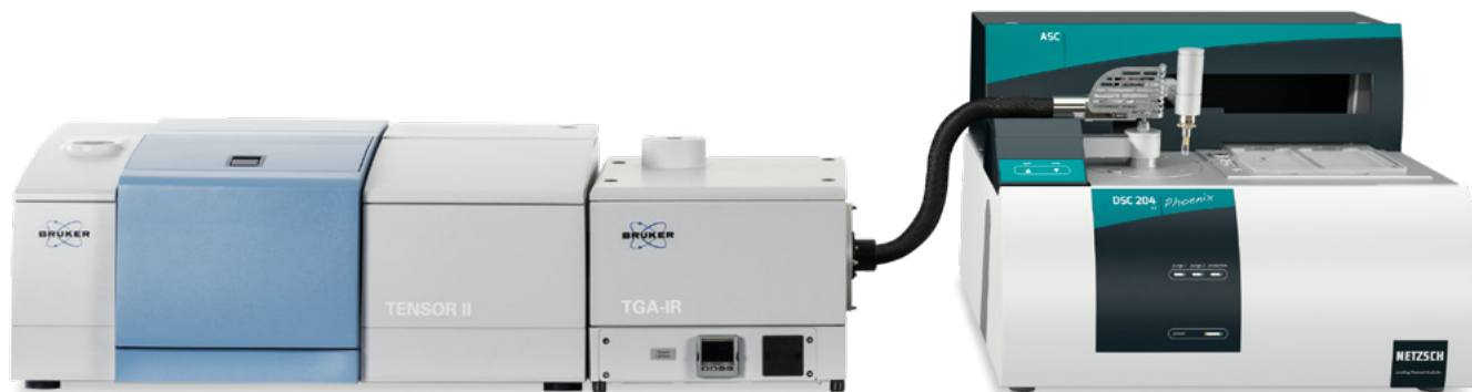
带自动进样器的DSC 204 F1 Phoenix ® 与Bruker TENSOR II FT-IR的扩展应用范围
