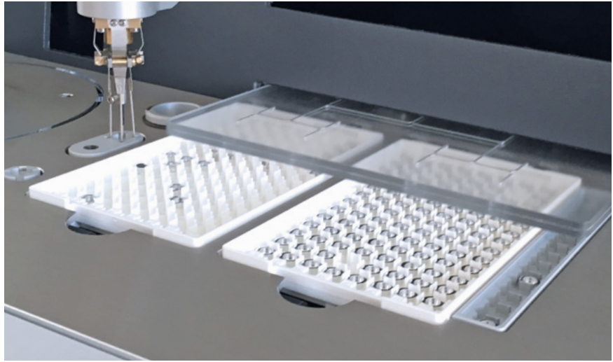
上图为两个可互换的3-in-1样品盒和一个固定进样条，可放置样品和参比坩埚，共204个位置，图中为样品盘盖部分打开的状态。每个3-in-1样品盒可放置不同类型的样品和参比坩埚。
