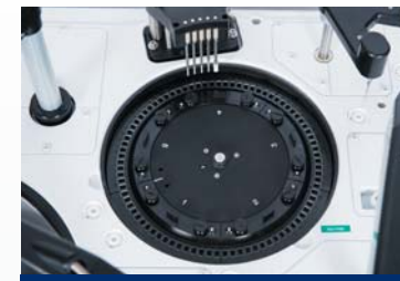
可重复使用直读式比色杯，光学质量自动监控
