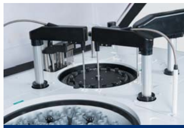
3个机械臂：1个取样品，2个取试剂
