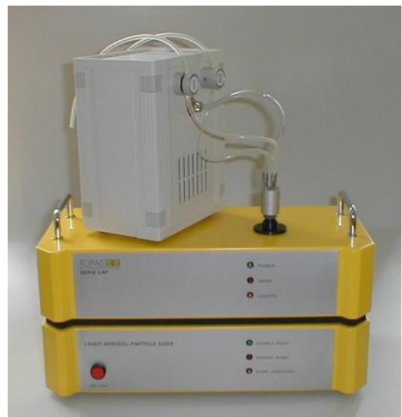
图 2 带上、下游切换阀的 LAP-322 粒径谱仪
