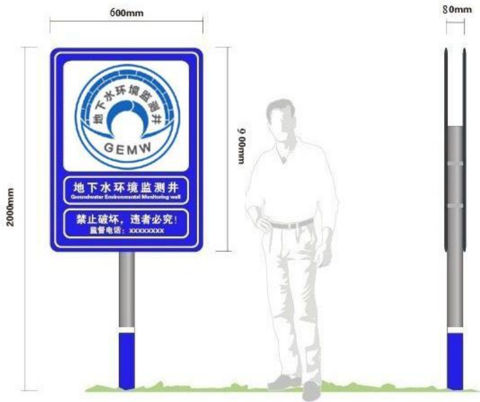
图 A.3 地下水监测井警示标图示及尺寸
