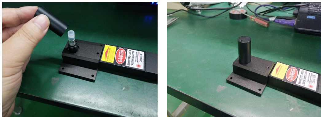
图 9 液体样品测量池（液相色谱瓶，微量）（选配）
