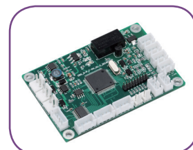
泵控制电路板
