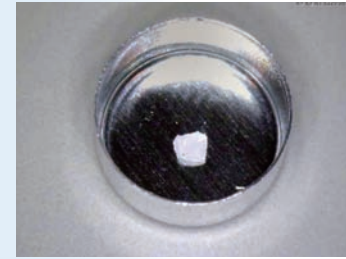
开放式样品坩埚(5mm直径) 0.1mg样品
