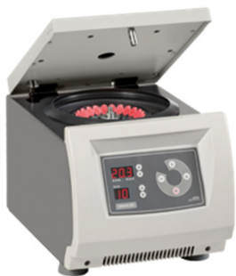
型号: BIOCEN22 最大容量: 24 x 2毫升 / 12 x 5毫升 最大速度: 21885 xg / 15000 RPM
