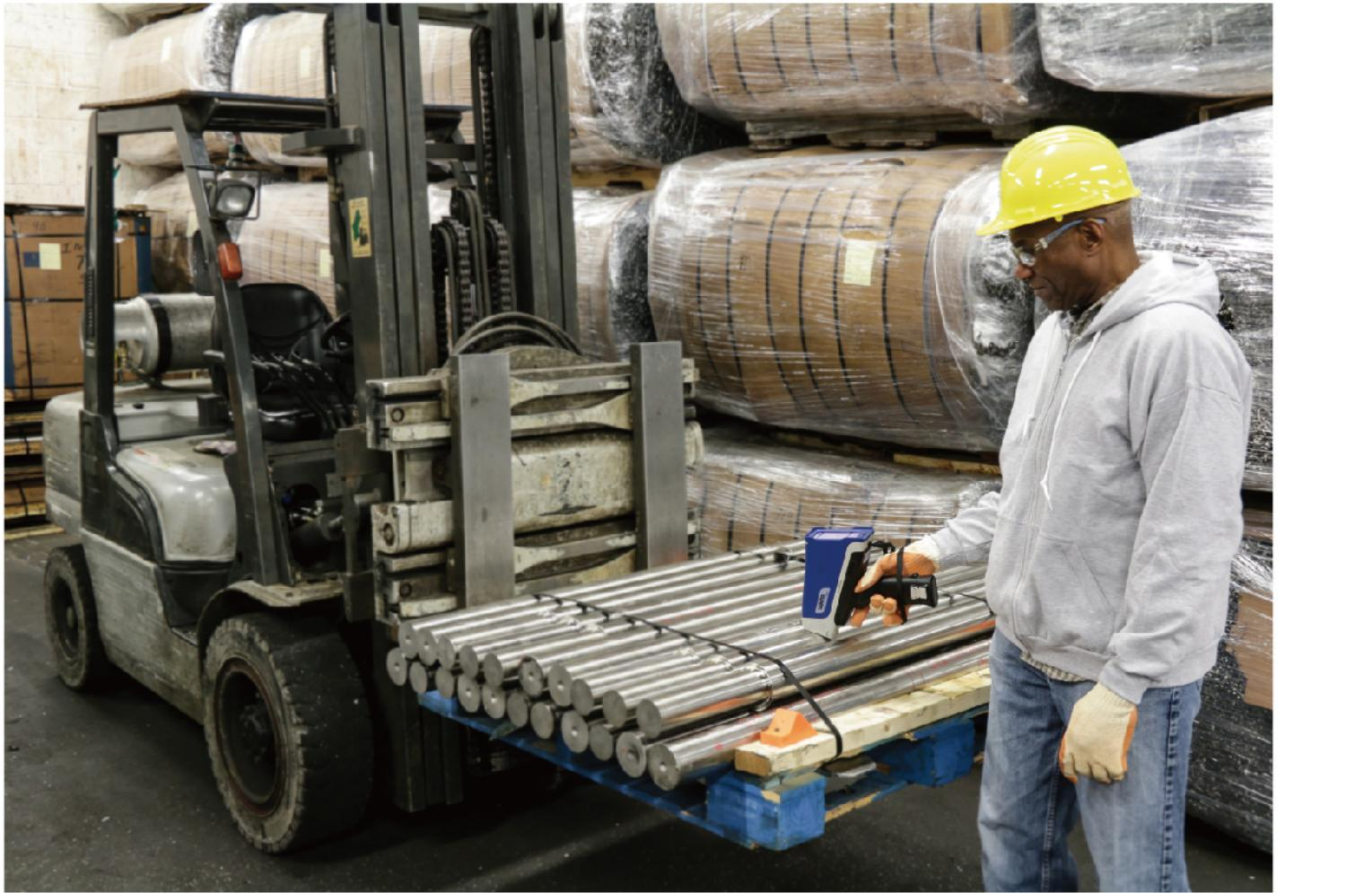
奥林巴斯新开发的Vanta分析仪是奥林巴斯迄今为止最先进的手持式X射线荧光（XRF）设备。这款坚固耐用、性能强大、简单直观的分析仪，可以为那些要求在野外环境获得精准分析水平的用户，进行快速高效的元素分析和合金辨别。
