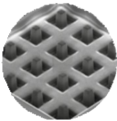
SEM图像具有明确定义的柱子的自动FIB制备应用程序的形状例如原子探针或微机械测试。 资料来源: FEI公司
