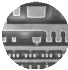
SEM图像逻辑器件 - 65 nm技术。 资料来源: FEI公司
