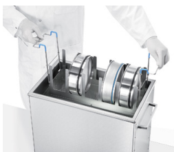
RK 1028 C 使用 SH 28 C 清洗多个分析筛
