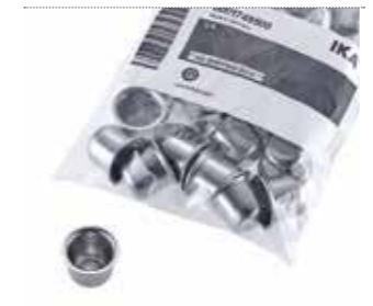
C 5 VA 标准燃烧坩埚套装 25 件; Ø 20 mm x 19.5 mm 高; 每个可满足约 25 次燃烧 订货号 1749500
