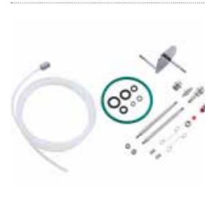
C 6000.12 配件套装 适用于 C 6000 量热仪和 C 6012 分解氧弹; 包括多个 O 形环和密封圈; 带排气管; 两个点火和接地电极; 4 根铂金点火丝; 一个完整顶针、一个喷头、两个压缩弹簧和若干备用螺母 订货号 4504400
