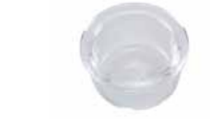
C 6 石英坩埚, 大号 Ø 26 mm x 18 mm 高; 填充热值较低的高容量材料; 特别适用于含灰量较高的样品; C 5010.5 坩埚盘, 要求大号 订货号 355100
