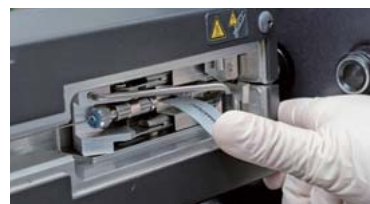
(3) 推动柱温箱控制杆完成色谱柱最后的固定
