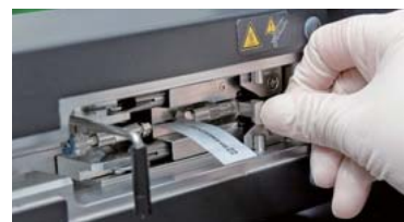
(2) 通过UF-Link将色谱柱固定在柱温箱的卡槽内
