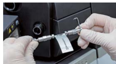
(1) 将接合器连接到色谱柱上，标准化的接合器可适用于多种色谱柱
