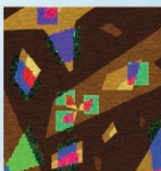
不同区域的拉曼成像图，背景为 AFM 形貌图
