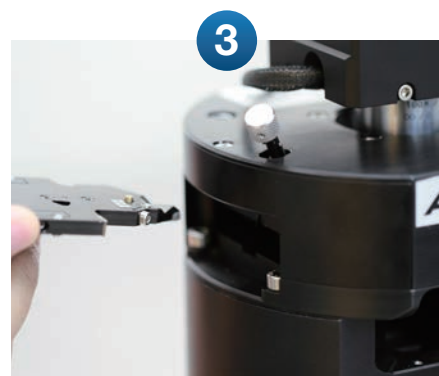
简便易操作：更换针尖不需要移动样品或改变光路
