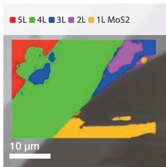
不同层状 MoS 2 的拉曼成像 - 低波数 (<30cm -1 ) 的层间振动峰
