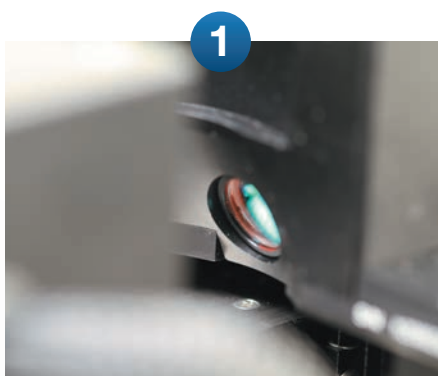
1300 nm AFM 激光反馈：对拉曼信号不产生干扰
