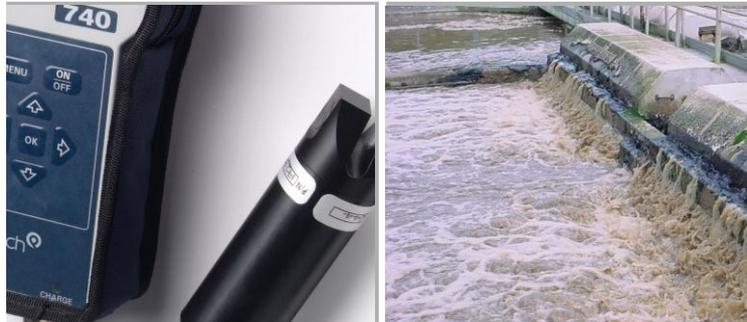
740便携式污泥浓度计为污泥浓度，污泥界面以及浊度测量提供了一个快速，精确，简单的解决方案，并且操作简单，方便。无需专业人员进行专业的培训。坚固的IP65防护外壳以及防磨设计让用户可以放心使用，无需担心掉落水中或者碰撞。高对比度LCD显示屏拥有超大的工作温度范围，任何时候都会非常清晰。
