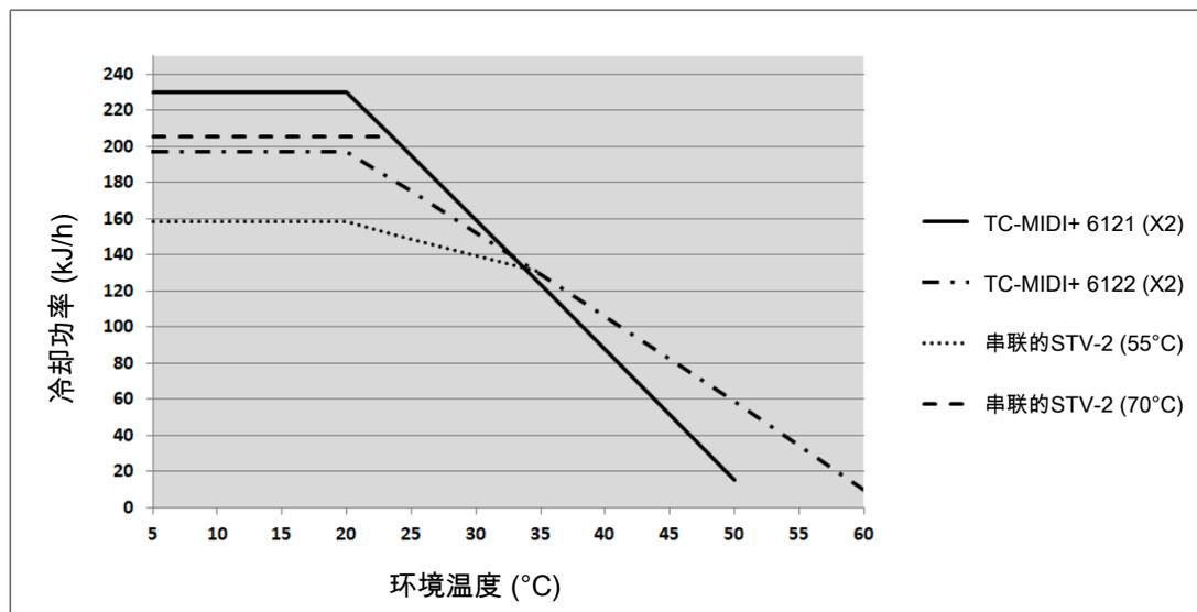
注释：换热器STG-2的性能等于冷却器的最大制冷功率。
