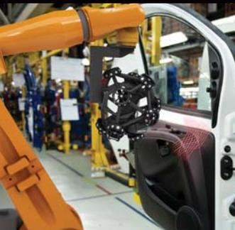
机器人装配式光学 CMM 3D 扫描系统属于 MetraSCAN 3D R-Series 系列, 是一款快速、精准的扫描解决方案, 专用于在生产线和车间环境对零部件进行自动化 3D 检测。
