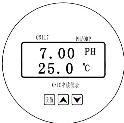
变送器操作按键及显示见左图。”设置”键为功能键，“▲”和“▼”键为数据改变键。”设置”与“▲”组合键为参数设置、仪表标定功能键。
