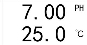
如果温度补偿电阻未连或补偿电阻超出补偿范围（0-100℃），仪表显示：E25.0。此时应检查温度补偿电阻的是否连接正确，电阻类型是否与传感器一致。按”设置”键（超过 4 秒），将切换到显示 mV 值状态：
