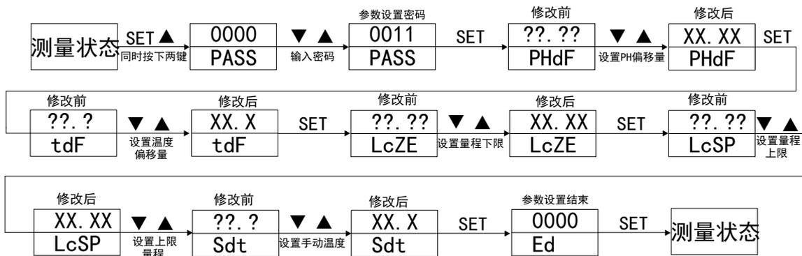
变送器的参数设置包括设置 PH 偏移量、温度偏移量、量程和手动温度。其操作流程见上图。
