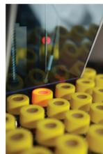
当对土壤样品进行编程时，Centurion的机械臂将会进入样品位置，并检测样品瓶是否在托盘中。Centurion使用的是光纤传感器，而不是不可靠的机械开关。一旦检测到，机械臂上的抓夹拿起这个样品瓶，然后把它移到加热的土壤站。之后，与内标混合的水将被添加到瓶中。在吹扫过程中，气体将进入小瓶，通过加热的传输线进入吹扫捕集浓缩仪。如果在瓶中加入了搅拌棒，在吹扫过程中，样品可以进行混合。
