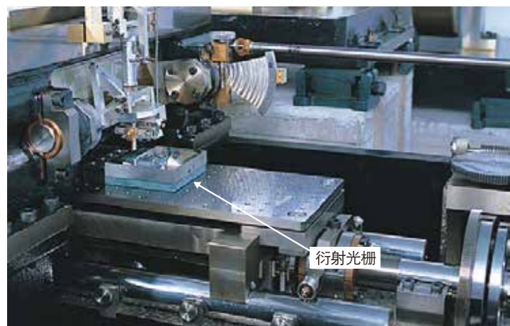
使用光栅刻划系统制造衍射光栅
