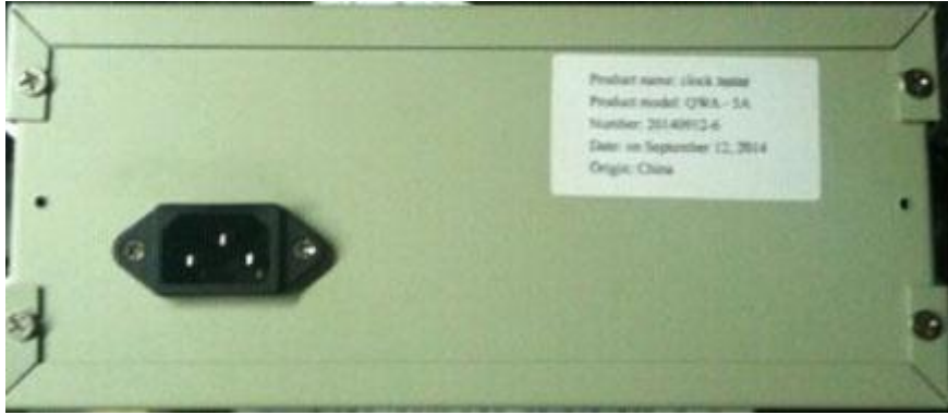
图 3. QWA-5A 时钟测试仪面板（背面）
