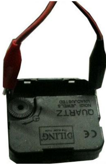
图 14. 石英机芯电流测试
