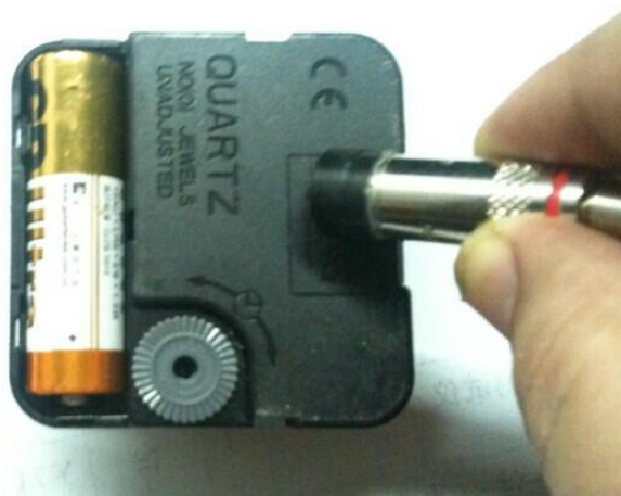
图 8. 探头测量石英机芯
