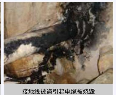
接地线被盗引起电缆被烧毁
