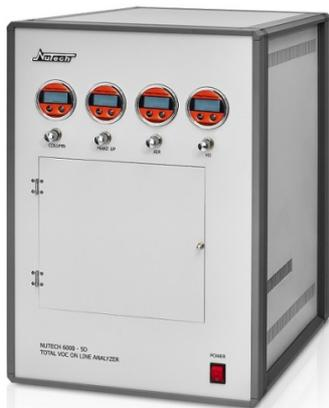
N6000-5D 可以连续在线分析空气中的各种单个 VOC（包括 56 种美国 EPA 提出的溴氧前体物或称光化学烟雾监控系统（PAMS）化合物和 EPA TO-15 的 65 种化合物），用户可以根据自己的需要选择目标化合物进行标定。并同时分析报告总挥发性有机物（TVOC）。
