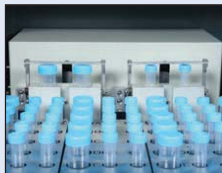
振摇模块：上下振荡样品或dSPE样品
