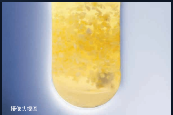
应用于 Monowave 400 的反应管类型
