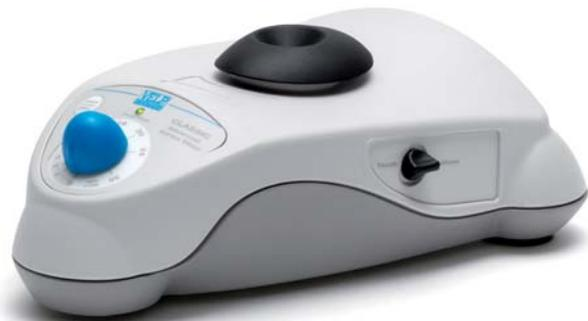
WIZARD是VELP在Vortex产品创新的代表作，其近红外技术传感操作模式在市场上是独一无二的。具有创新的外观设计，舒适的操作体验。具有两种操作模式，传感器式和连续式。在传感器模式下无需压力即可开始混匀。在连续模式下可以选择多样的配件，可以用来混匀多种规格的样品6管。
