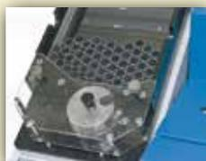
采用一个旋转机构准确地获取坩埚并定位，坩埚料仓的最大储备量为 100 个，除放置常规坩埚外，也可放置长坩埚。
