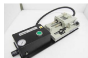
快速混合附件（含气动传动装置） 利用停流技术监测溶液中的动力学反应。
