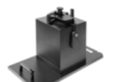
积分球 测量吸光度和量子产率较低的液体、固体样品的绝对量子产率。
