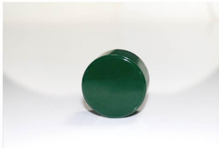
模具倒角设计，样品自带倒角，方便后续研磨抛光
